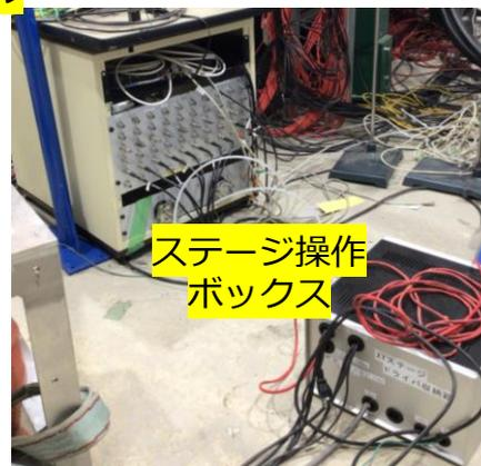
ステージ操作：1mm1000ステップでXY方向に調節可能
